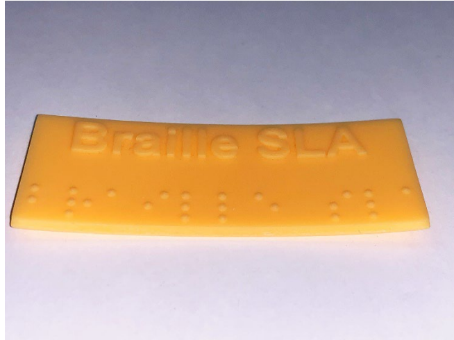
Figura 7 Deformazione dei componenti stampati piatti
